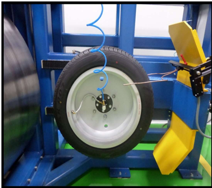
เครื่องทดสอบสมรรถนะความเร็วและการรับโหลด รถยนต์นั่งและรถบรรทุกเล็ก (มอก.2718, UN R 30)
