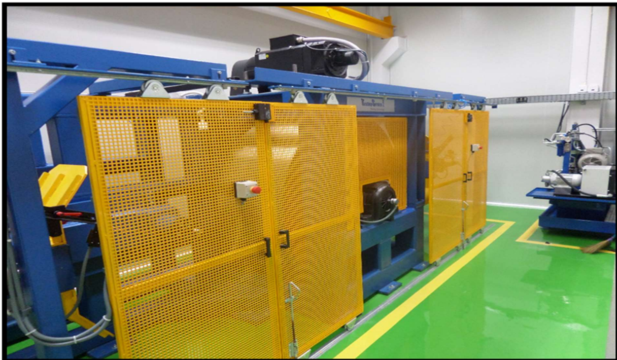
เครื่องทดสอบสมรรถนะความเร็วและการรับโหลด รถจักรยานยนต์ (มอก.2720, UN R 75)
