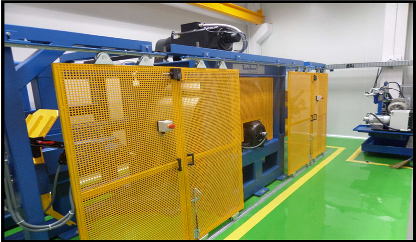
เครื่องทดสอบสมรรถนะความเร็วและการรับโหลด รถยนต์นั่งและรถบรรทุกเล็ก (มอก.2718, UN R 30)
