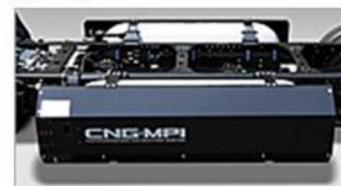
(2)CNGポンプユニット
